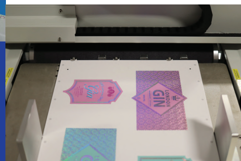
Margeur avec séparation des supports par soufflerie
